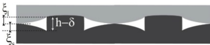
FIGURE V.1 – Déformations visibles sur deux plots avec ses notations.
