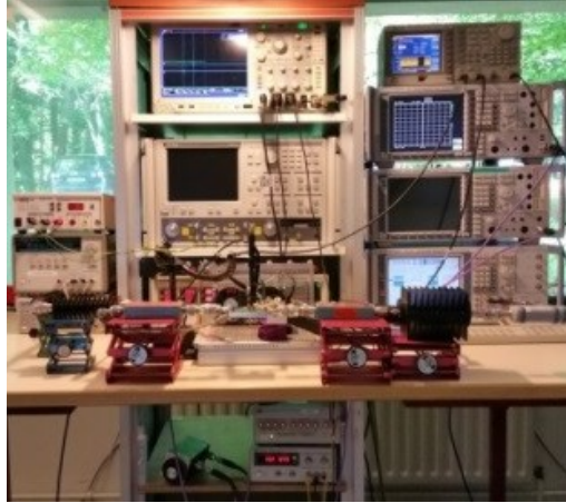
Figure V-3: Photographie du banc de mesure temporelle d'enveloppe.
