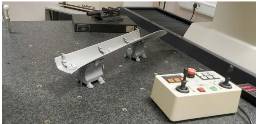
Figure 97 : Mesures à l'état libre
