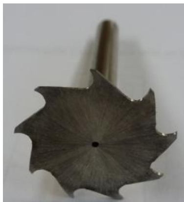
Figure 2.62 : Fraise 2 tailles utilisées pour le prélèvement des échantillons
