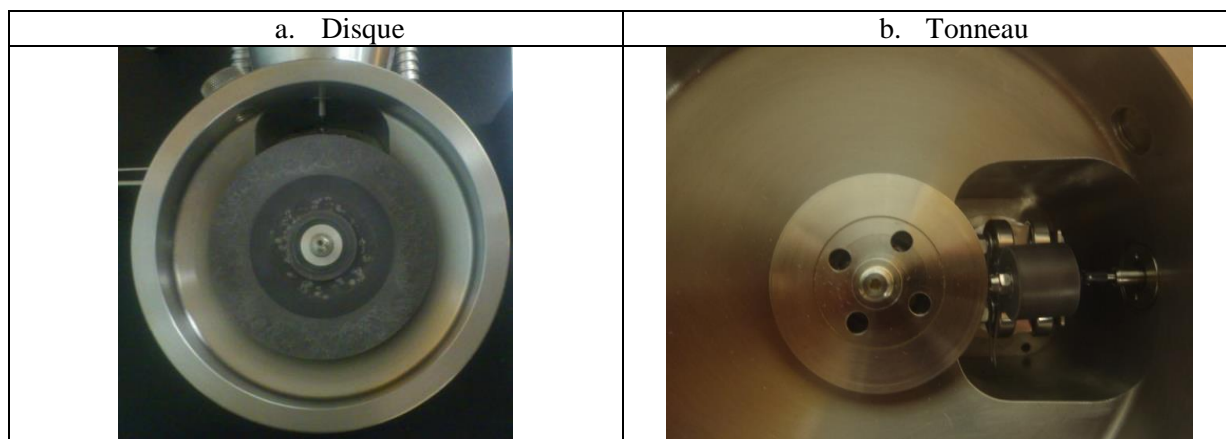
Figure 2.86: Dispositif de mesure : (a) disque et (b) tonneau
