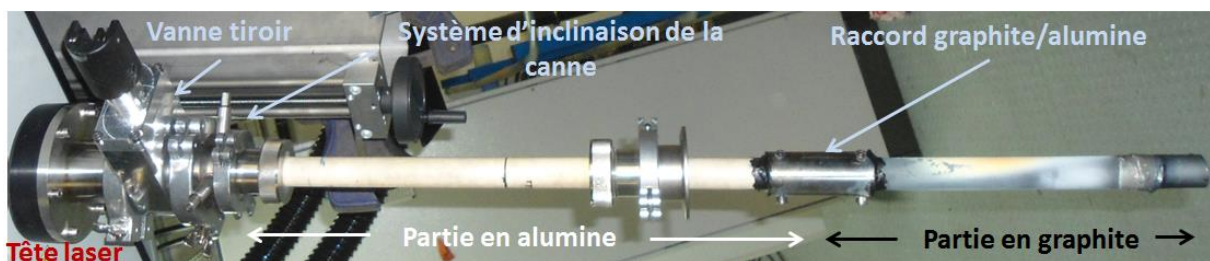
Figure 29 : Canne de bullage hybride montée sur la tête laser.
