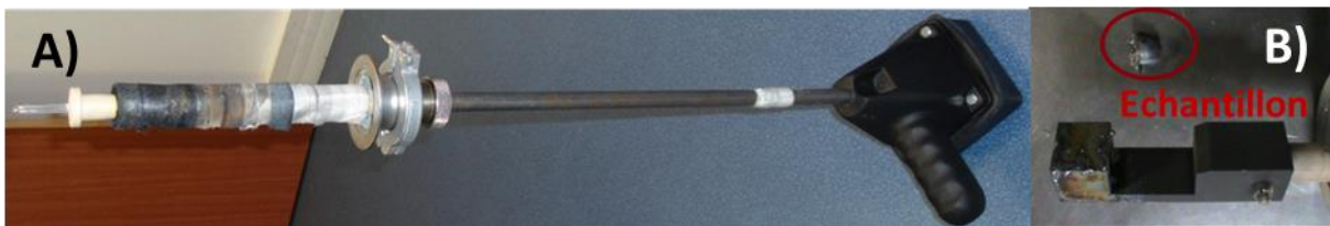
Figure 25 : Dispositifs de mesure de température (A) et de prélèvement d'échantillon dans le bain liquide (B).
