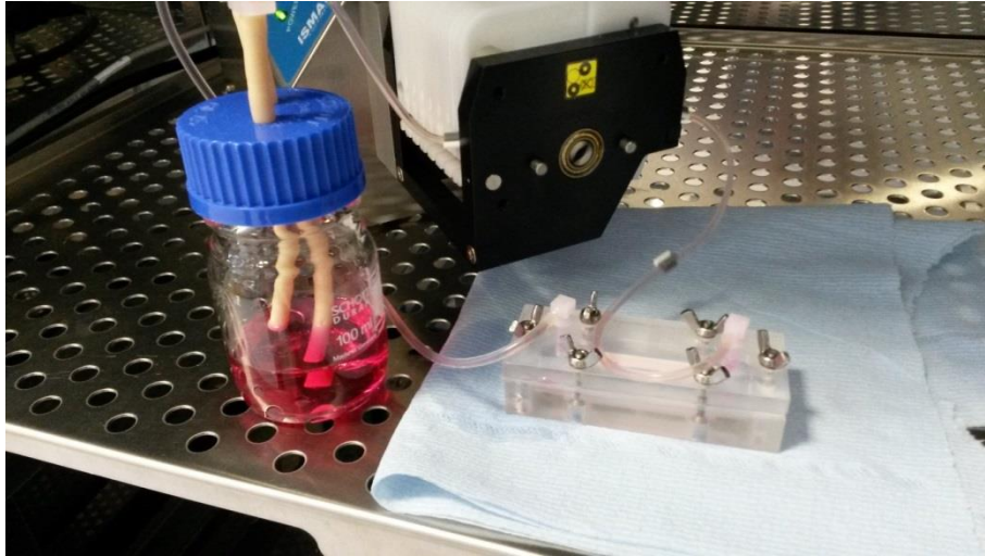
Figure V-3 : Dispositif pendant une expérience de cisaillement sur une lame de corail de bécitier.
