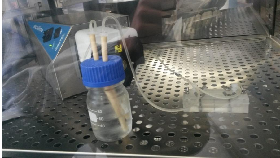
Figure V-1 : Dispositif de cisaillement développé. Sur la photo sont visibles la pompe, le circuit de tubulures, le flacon réservoir et le dispositif en lui-même, fermé hermétiquement grâce à un système de vis-écrous.
