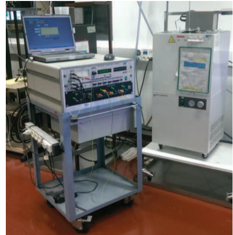
Figure 3-8 : Dispositif expérimental servant à étalonner les sondes Pt100
