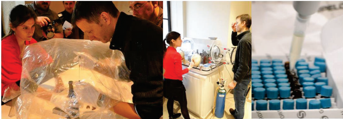
Figure 18: Compilation de photos illustrant l'échantillonnage sous argon dans une boîte à gants gonflable, une boîte à gants rigide et enfin les échantillons en cours de remplissage lors des prélèvements.
