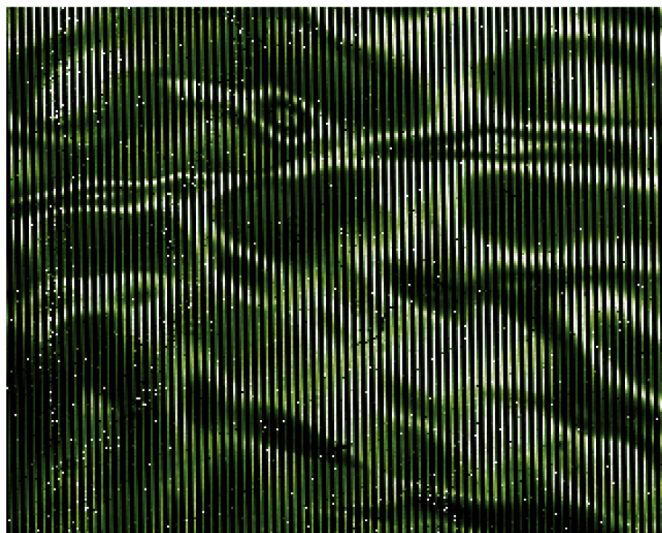
FIGURE 1.18: Cartographie de la réponse monochromatique de l'instrument MISTERE, à \sigma = 1050,7\text{cm}^{-1}
