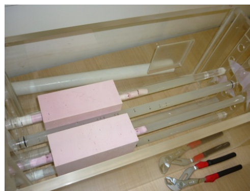
FIGURE 7.3 – Fantôme anthropomorphe avec les objets tests introduits dans les différents cylindres
