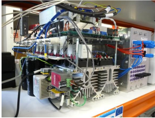
Figure 3-11: Photographie du prototype du convertisseur multiniveau 3LNPC
