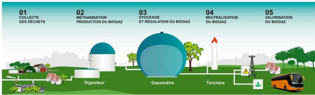
Figure 1-4: Principales étapes de la méthanisation des déchets [11]
