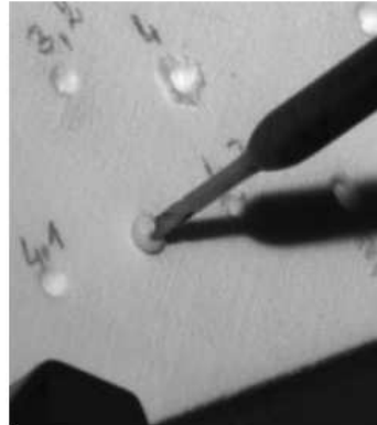
(b) Solidification des copeaux autour de l'outil.
