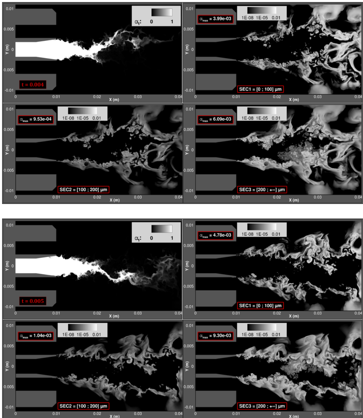
FIGURE 10.28 – Évolution temporelle des fractions volumiques : phase liquide dans CHARME et les trois sections de la phase dispersée. Simulation S2 pour t = 0.004 et t = 0.005 secondes.
