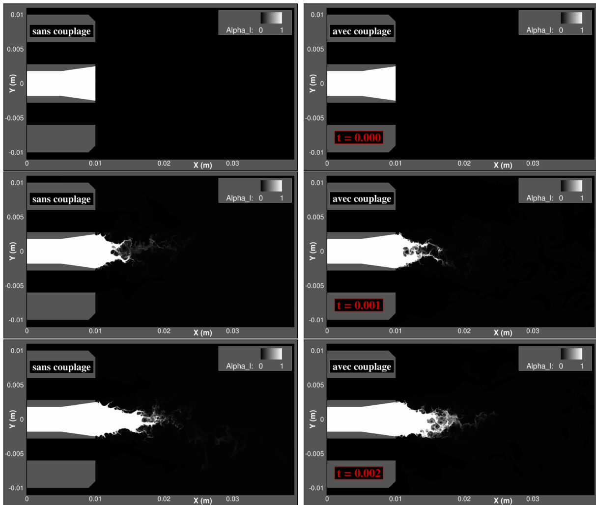
FIGURE 10.18 – Champs instantanés de la fraction volumique de liquide dans CHARME, pour t = 0 , t = 0.001 et t = 0.002 secondes. Comparaison des simulations S1 et S2 (sans et avec couplage).
