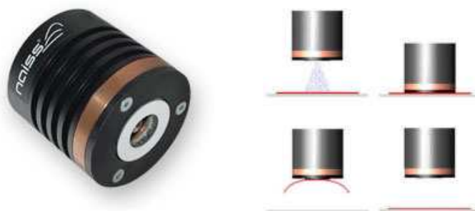
Figure 1.8 : Préhenseur à froid, illustration du principe de préhension : vaporisation d'eau, refroidissement à -10^\circ\text{C} pour créer l'adhésion, saisie puis dépose (www.naiss.de).
