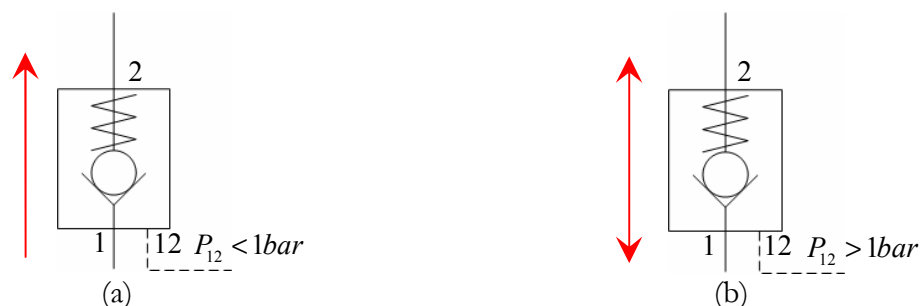
Figure 4.14 : Illustration du fonctionnement d'un clapet anti-retour piloté, (a) entrée 12 non-pilotée : écoulement unidirectionnel, (b) entrée 12 pilotée : écoulement bidirectionnel.
