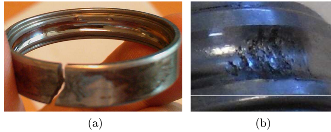
FIGURE 1.14: Exemples de dégradations : (a) dégradation de la bague externe et (b) dégradation de la bague interne.
