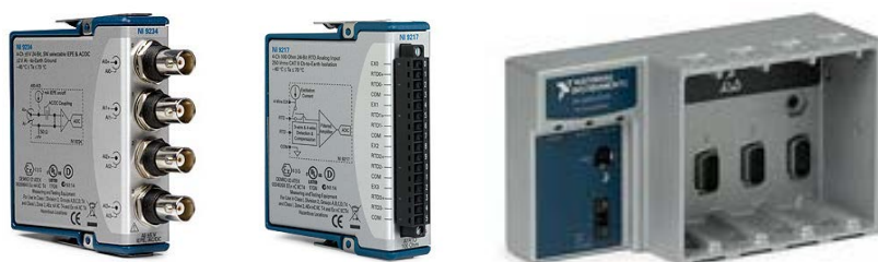
FIGURE 1.7: De gauche à droite : carte d'acquisition de vibrations, de température et châssis externe à l'ordinateur.
