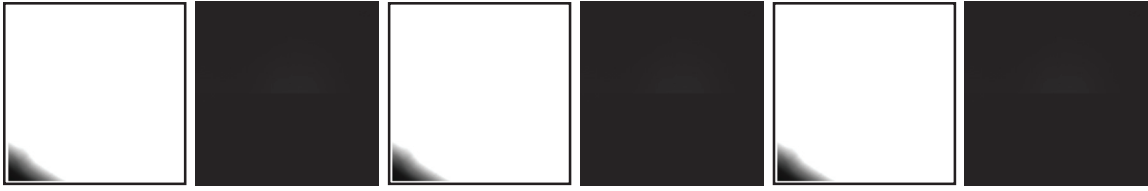
FIGURE 3.8 – Images successives du clignotement d’une diode à demi-fréquence de la fréquence de la caméra
