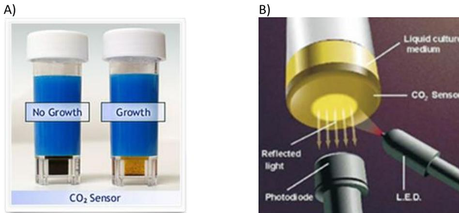
Figure 1.1 : Flacons pour la détection du CO<sub>2</sub> émis par les micro-organismes. A) flacon BioLumix, [3] B) flacon BacT/Alert. [4]
