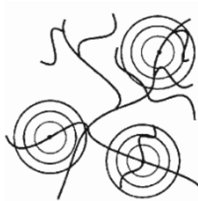
Figure 2-7. Illustration de la méthode de croissance d'une boule sur un objet (Landini, Murray, & Misson, 1995).
