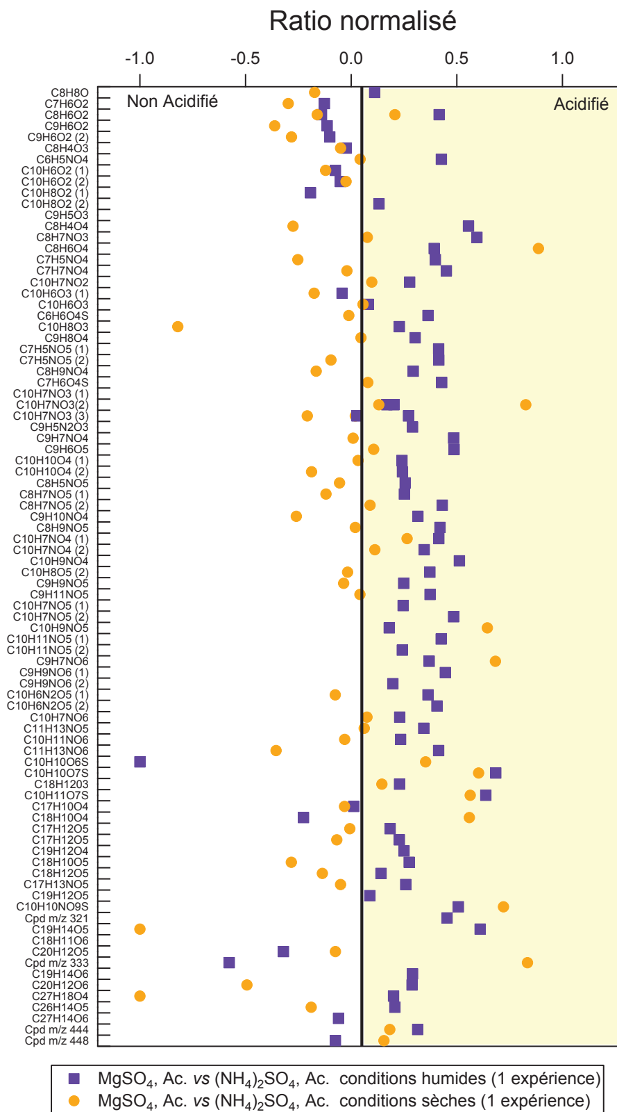
Figure IV.17: Ratio normalisé des composés identifiés en phase particulaire, formés suite à la photooxydation du naphthalène en conditions humide et sèche, en présence de NO x et de particules d'ensemencement acidifiées (Ac.) de sulfate d'ammonium et de magnésium.
