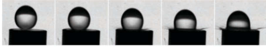
FIGURE 4.12 – Figure 3a de Vernay et al. (2015) représentant une goutte avant et après l’impact sur une cible de diamètre légèrement plus grand. Une nappe liquide se forme et commence ensuite à s’étendre. La configuration qui nous intéresse est différente puisque la ligne de contact est accrochée au support solide avant l’impact (voir les Fig. 4.3 et 4.4). Les conditions initiales sont par conséquent différentes.
