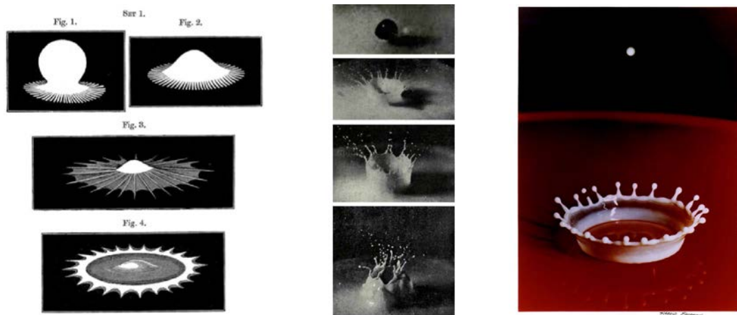
FIGURE 1.3 – Quelques travaux pionniers sur l’impact de goutte. (a) Set 1 issu de Worthington (1876) représentant l’impact d’une goutte de mercure tombant sur une plaque de verre. (b) Splash généré par l’impact d’une goutte d’eau colorée dans du lait ( Worthington et Cole 1897 ) (c) Corona splash induit par une goutte de lait ayant impacté un film fin photographié par Edgerton et Killian (1954) .
