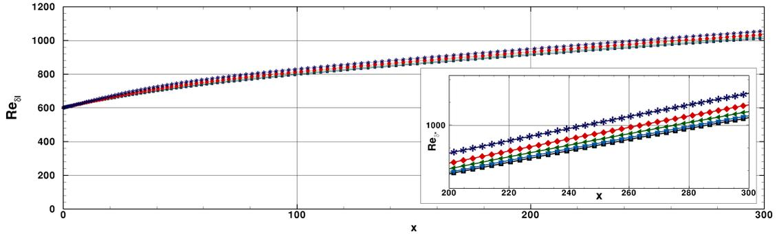
FIGURE 3.12 – Évolution du nombre de Reynolds  $Re_{\delta_i}$  basé sur l'épaisseur de déplacement locale de la couche limite en fonction du nombre de Mach (■)  $Ma = 0.1$ , (▼)  $Ma = 0.3$ , (◁)  $Ma = 0.5$ , (◆)  $Ma = 0.7$ , (\*)  $Ma = 0.9$
