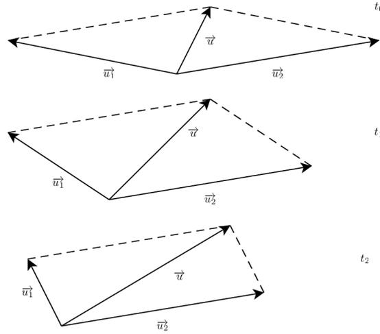
FIGURE 1.6 – Illustration du principe de croissance transitoire
