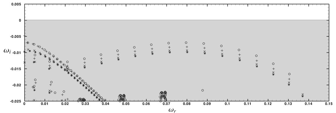
FIGURE 3.15 – Diagramme de stabilité de couche limite pour un écoulement à  $Ma = 0.1$ ,  $Re_{\delta_l} = 600$  pour  $N_y = 50$  et (o)  $N_x = 100$ , (+)  $N_x = 150$ , (x)  $N_x = 200$ , (\*)  $N_x = 250$
