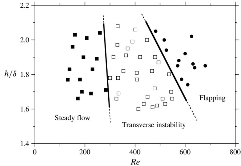
FIGURE 5.1 – Diagramme de stabilité d'un écoulement décollé incompressible en fonction de la hauteur de bosse adimensionnée  $h^* = h/\delta_l$  et du nombre de Reynolds  $Re_{\delta_l}$  (Passaggia *et al.* ([51]))
