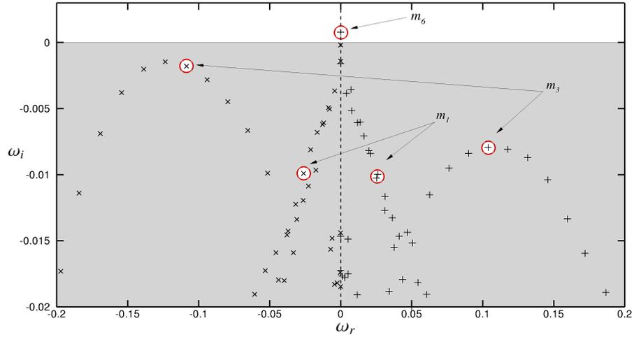
FIGURE 5.4 – Spectre de stabilité globale pour  $Ma = 0.1$ ,  $Re_{\delta_i} = 400$  ( $\times$ ) :  $\beta = 0$ , ( $+$ ) :  $\beta = 0.25$ . A gauche sont représentées les valeurs propres associées à la partie du spectre pour lequel  $\omega_r \leq 0$  et à droite les valeurs propres associées aux fréquences  $\omega_r \geq 0$  (le spectre de stabilité étant symétrique)
