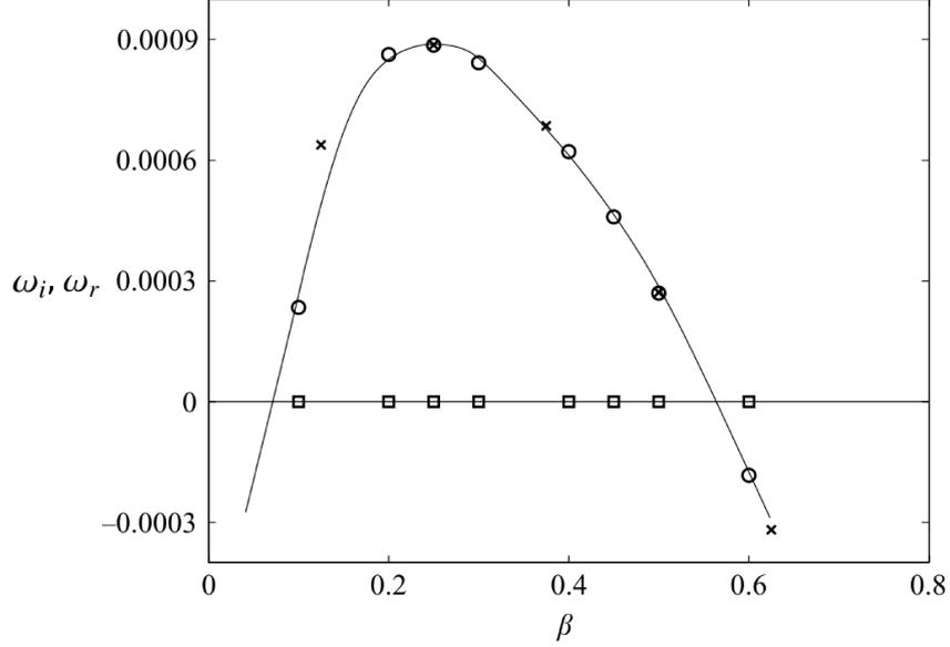
FIGURE 11 – Taux d’amplification ( $\circ$ ) et fréquence ( $\square$ ) du mode globale le plus instable pour  $Re_{\delta_i} = 400$  en fonction du nombre d’onde transverse  $\beta$ . Les taux d’amplification issus de la simulation directe sont également présentés ( $\times$ ) (Gallaire, Marquillie et Ehrenstein [56])
