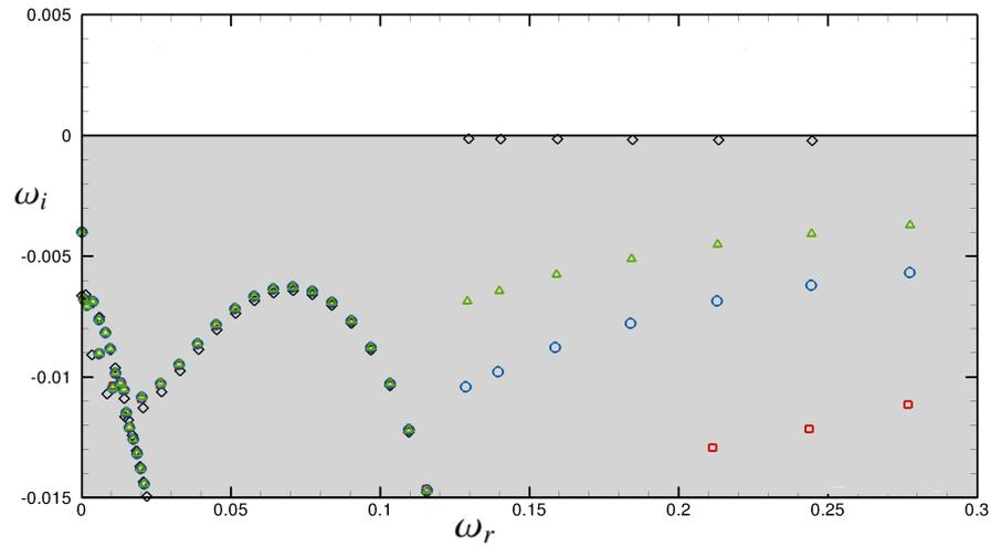
FIGURE 3.21 – Évolution du diagramme de stabilité d'une couche limite à  $Ma = 0.2$  et  $Re_{\delta_l} = 600$  en fonction de la variation du coefficient d'atténuation  $\sigma_y$  dans la zone PML. ( $\diamond$ ) sans zone absorbante, ( $\square$ )  $\sigma_y = cst$ , ( $\circ$ )  $\sigma_y = f(y)$  et ( $\triangle$ )  $\sigma_y = f(y^2)$
