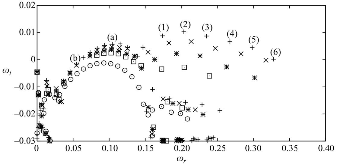
FIGURE 8 – Diagramme de stabilité globale d'un décollement de couche limite induit par une géométrie de type bosse à  $Re = 590$  pour différentes hauteurs de bosse  $h/\delta_l = 1.8(\odot)$ ,  $h/\delta_l = 1.85(\square)$ ,  $h/\delta_l = 1.9(*)$ ,  $h/\delta_l = 1.95(\times)$ ,  $h/\delta_l = 2.0(+)$  (Ehrenstein et Gallaire [51])
