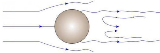
FIGURE 1.4 – Écoulement instationnaire turbulent  $300 < Re$
