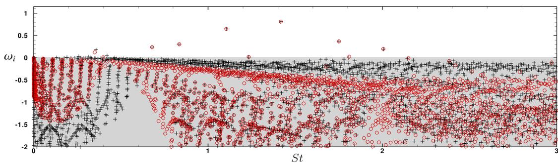
FIGURE 4.8 – Diagramme de stabilité d'un écoulement de cavité ouverte pour  $L/\theta_0 = 130$  à  $Ma = 0.9$  et  $Re_L = 7500$ ; (+) sans zone absorbante, ( $\circ$ ) avec zone absorbante  $y \geq 2.5$ ,  $\sigma_y = 15.0$
