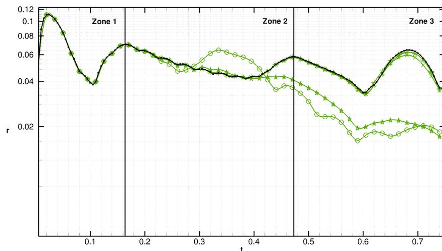
FIGURE 3.7 – Évolution de  $r$  au cours du temps pour une zone absorbante de type  $Za2$  pour une (.) solution de référence, (+)  $\min Re = 100$ , ( $\times$ )  $\min Re = 50$ , ( $\odot$ )  $\min Re = 1$ , ( $\circ$ )  $\min Re = 0.1$
