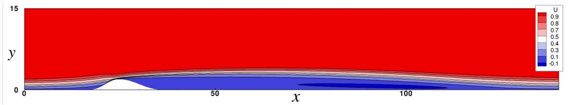
FIGURE 1.5 – Écoulement stationnaire de couche limite décollée
