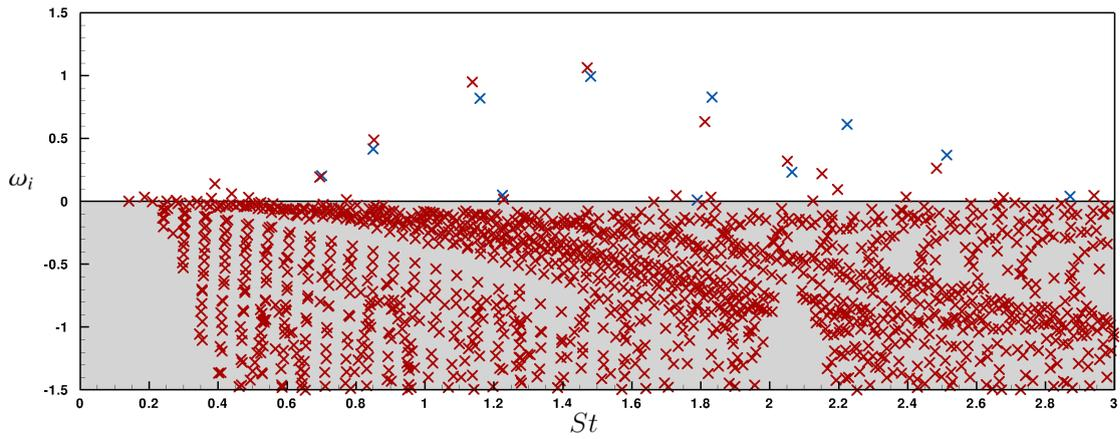
FIGURE 4.7 – Diagramme de stabilité d'un écoulement de cavité ouverte  $L/\theta_0 = 200$  à  $Ma = 0.9$  et  $Re_L = 7500$ ; ( $\times$ ) approche matricielle, ( $\times$ ) résultats de Yamouni *et al.* avec  $L/\theta_0 = 230$
