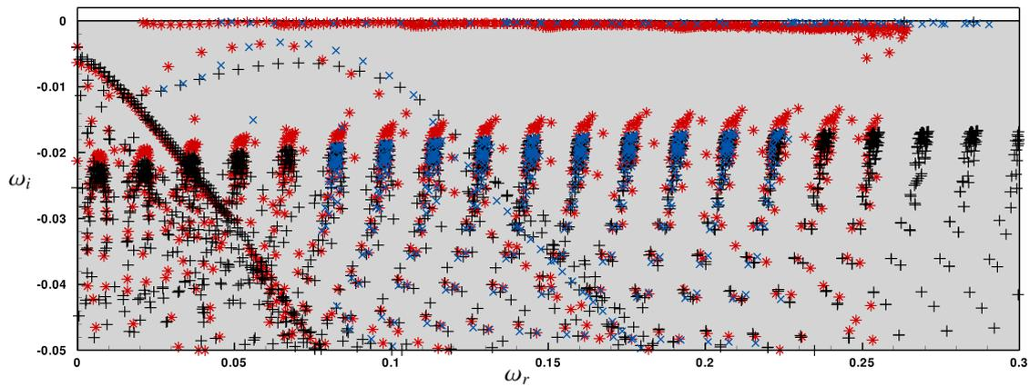
FIGURE 3.17 – Comparaison des spectres de couche limite obtenus pour  $Re_{\delta_i} = 600$  et  $(+)$   $Ma = 0.1$ ;  $(\times)$   $Ma = 0.5$ ;  $(*)$   $Ma = 0.8$
