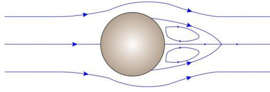
FIGURE 1.2 – Écoulement décollé stationnaire  $5 < Re < 48$
