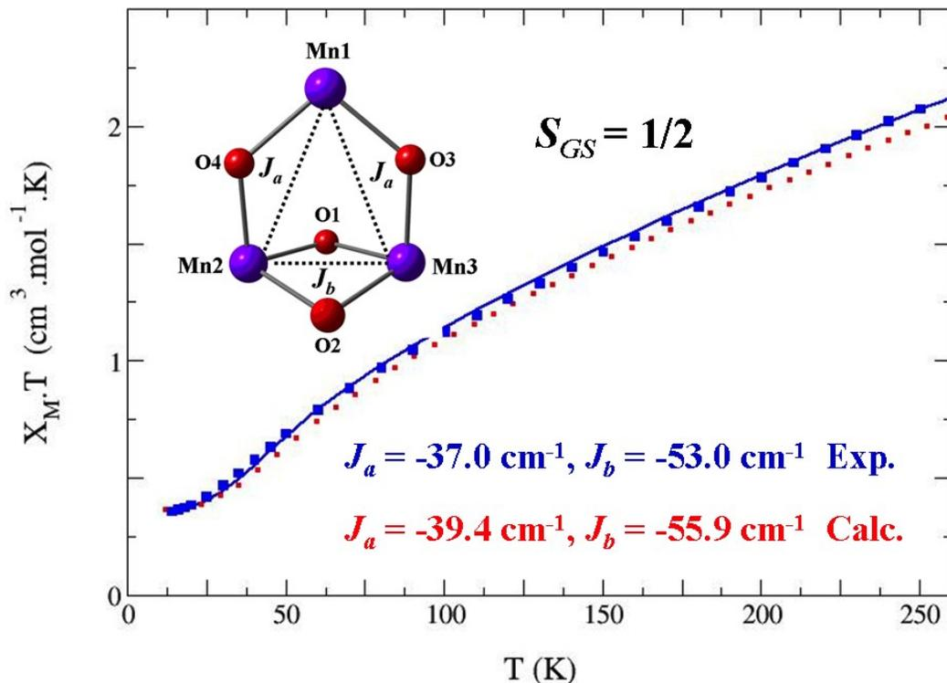
Figure 7 : Propriétés magnétiques du complexe trinuécléaire.
