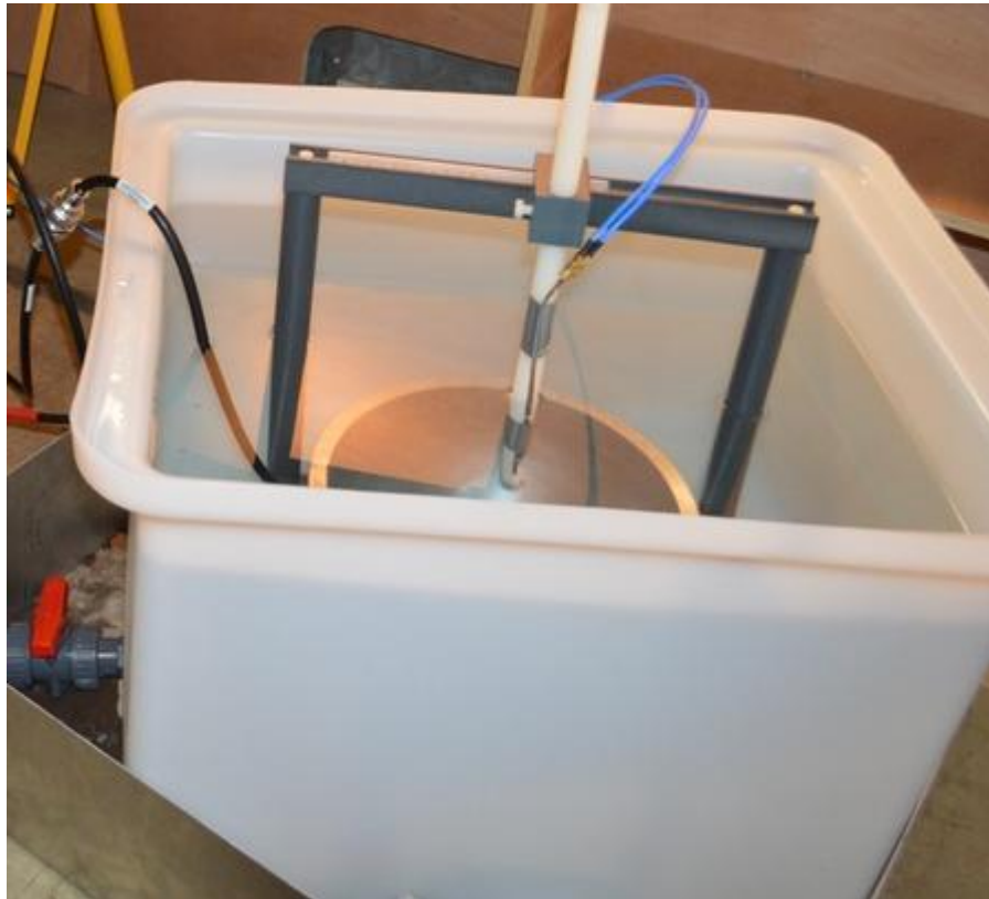
Figure III-79 Zoom sur l'antenne et la bassine contenant l'eau distillée
