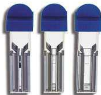
Figure II-2 Cuvette d'électroporation avec différentes distances inter électrodes
