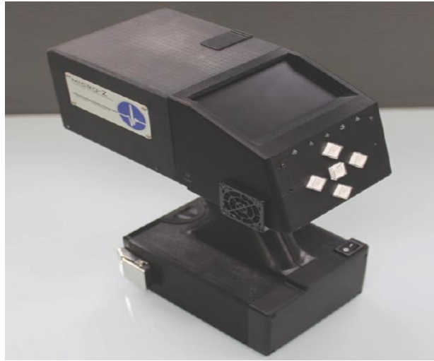
Figure 23. Photographie d'un prototype de lecture THz portable commercialisé par la société Zomega
