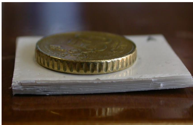
Figure 36. Photographie d'un prototype de tag THz base PEBD réalisé par pression à chaud
