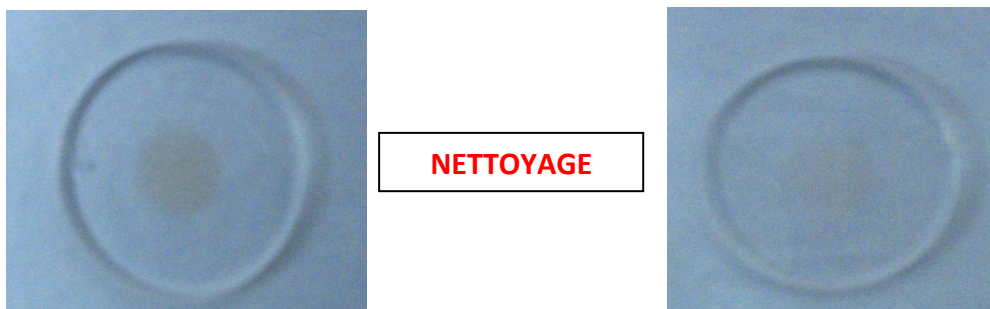
Figure A4.2 : Photographies présentant l'état du hublot avant (à gauche) et après (à droite) le nettoyage avec de l'acétone et du méthanol
