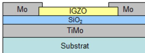
Figure 3-9 : Gravure des électrodes de source et drain
