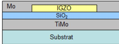
Figure 3-8 : Dépôt du métal de source et drain
