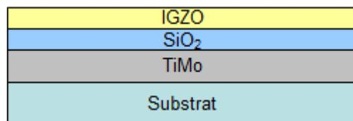
Figure 3-6 : Dépôt de la couche active d'IGZO
