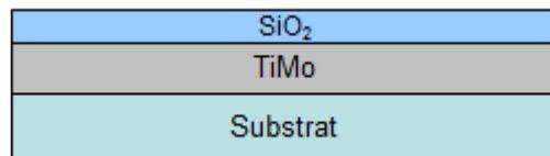
Figure 3-5 : Dépôt de l'isolant de grille
