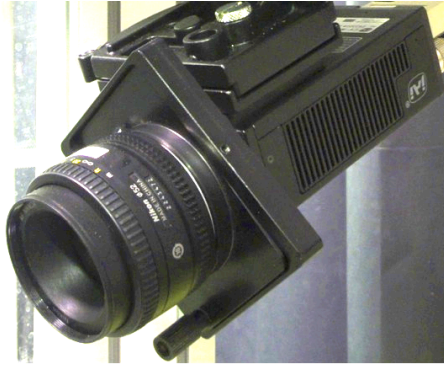
FIGURE 7.7 – Réglage Scheimpflug montrant le décalage entre le plan de l'objectif et le plan focal de la caméra.
