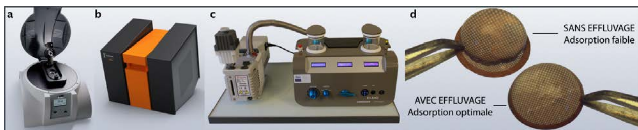
FIGURE 2.23 – Appareils pour la caractérisation de NPs. a - Granulomètre Vasco (Cordouan Technologies) pour la mesure du diamètre hydrodynamique de NPs en solution. b - Zetamètre Wallis (Cordouan Technologies) pour la mesure du potentiel zéta en solution. c - Système d'effluage pour grilles de MET Elmo (Cordouan Technologies). d - Effet d'un effluage sur le dépôt d'un échantillon liquide sur la grille de MET.
