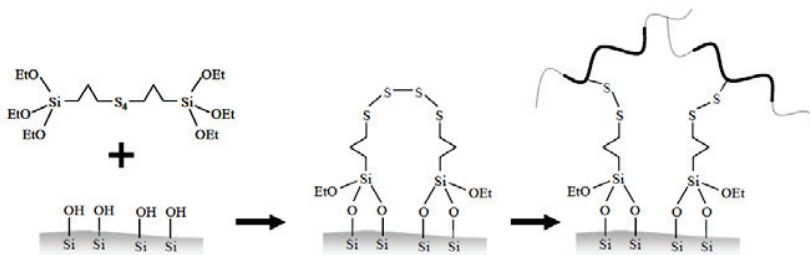
Figure III-14. Réactions de silanisation puis de couplage entre l'élastomère et la silice [19]
