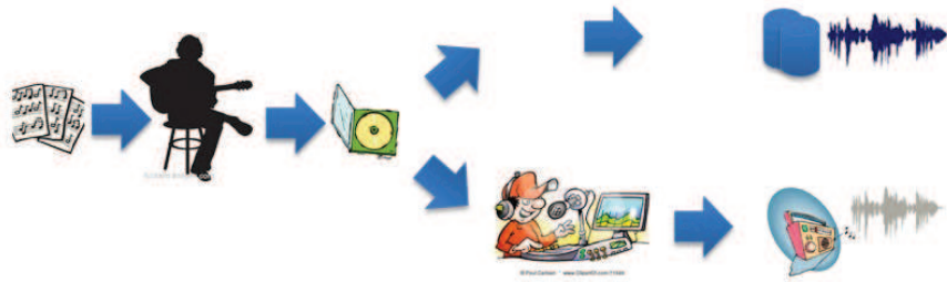
Figure 1.3: Illustration de l' identification exacte . L'algorithme doit associer deux signaux qui correspondent au même enregistrement avec différents post-traitements.
