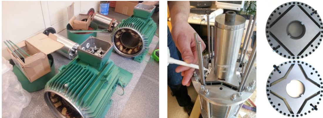
Figure 8 Réalisations des prototypes à partir de machines asynchrones du marché (à gauche), montage des aimants (au centre) et 2 types de tôles rotoriques (à droite)
