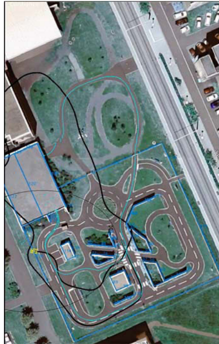
FIGURE VII.13 – Localisation dynamique réalisée à l'estime avec un odomètre et un capteur d'angle au volant. En noir : la trajectoire estimée, en cyan : la trajectoire fournie par le récepteur GPS RTK. Le véhicule représenté en jaune se trouve au point d'arrivée, le point de départ se trouve au milieu du carrefour (près des passages piétons). Le véhicule passe dans le garage, occultant le signal GPS, aussi à cet endroit la trajectoire de référence n'est pas disponible.
