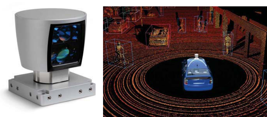
FIGURE III.2 – Vélodyne : A gauche une photo du capteur, à droite un exemple d'image 3D fournie par le vélodyne
