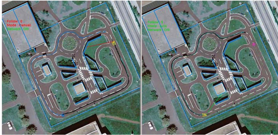
FIGURE VII.28 – Navigation automatique avec récupération de trajectoire : suivi de la trajectoire du vipalab5 par le vipalab3. À gauche, le véhicule vipalab3 (en jaune) avec sa trajectoire estimée (en noir) est visible ainsi qu’une pastille bleue montrant le vipalab5, ce dernier se trouve sur la trajectoire du vipalab3 et la suit. À droite, le véhicule vipalab5 (en jaune) avec sa trajectoire estimée (en noir) est visible ainsi qu’une pastille bleue montrant le vipalab3
