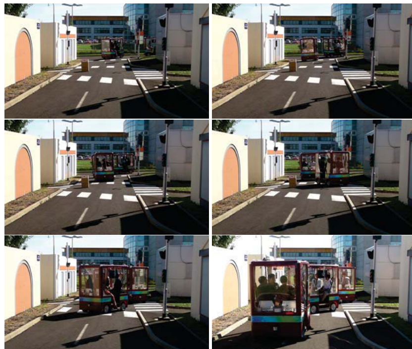
FIGURE VII.26 – Évolution temporelle du convoi de véhicules avec évitement d'obstacles (à lire de gauche à droite et de haut en bas).
