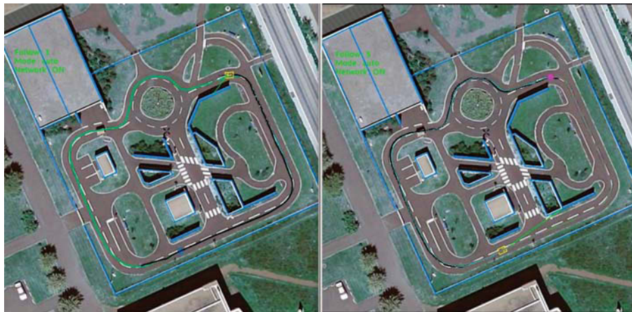
FIGURE VII.29 – Navigation automatique avec récupération de trajectoire : les deux véhicules suivent la trajectoire précédente de l’autre. À gauche, le véhicule vipalab3 (en jaune) avec sa trajectoire estimée (en noir) est visible ainsi qu’une pastille bleue montrant le vipalab5. À droite, le véhicule vipalab5 (en jaune) avec sa trajectoire estimée (en noir) est visible ainsi qu’une pastille bleue montrant le vipalab3
