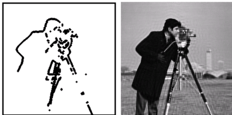
Figure 5.16 Bords de l'image CAMERAMAN et image restaurée : à gauche bords de l'image; et à droite image restaurée avec réduction des suroscillations. Obtenu de [44].
