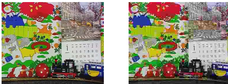
Figure 5.3 a: Image originale, absence de blocs b: Image jpeg compressée à 10%.
