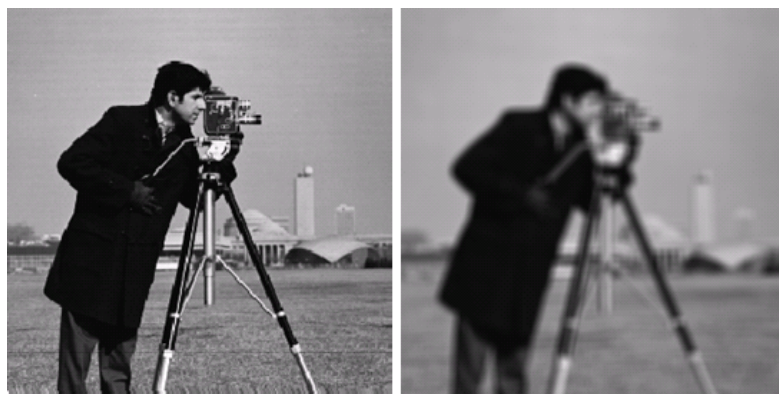
Figure 5.13 Image CAMERAMAN : gauche (a) : image originale et droite (b) : image floutée par convolution avec PSF. Obtenu de [62].
