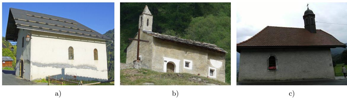
Fig. II.30 Type de clocheton. a) Saint-Ours, Adray, Arèche : pas de clocheton (clocher hors œuvre). b) Sainte-Marie-Madeleine, les Vincendières, Bessans : clocheton pesant en façade. c) Sainte-Anne, Le Mont, Sallanche : campanile appuyé sur la charpente.
