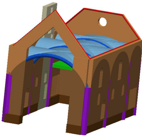
Fig. IV.32 Modèle final de la nef pour l'optimisation, NDG type n° 5.
