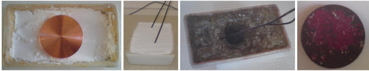
Figure 2.8. Résultats avant/après test de compatibilité thermochimique.
