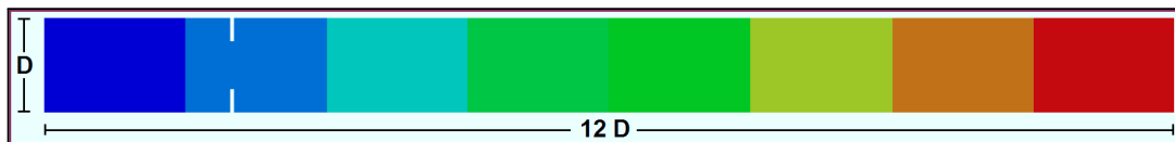
FIGURE 9.2 – Configuration géométrique du canal. Le maillage comporte 70000 cellules, soit une résolution \Delta x = 0.5 mm. Les couleurs correspondent aux partitions MPI.
