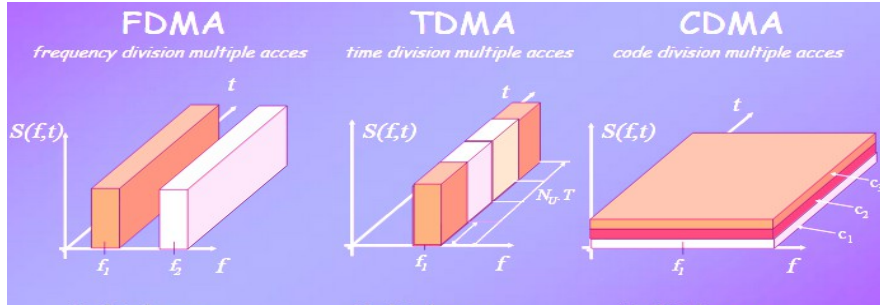
FIGURE 3.1 : Techniques d'accès multiple FDMA, TDMA, CDMA.
