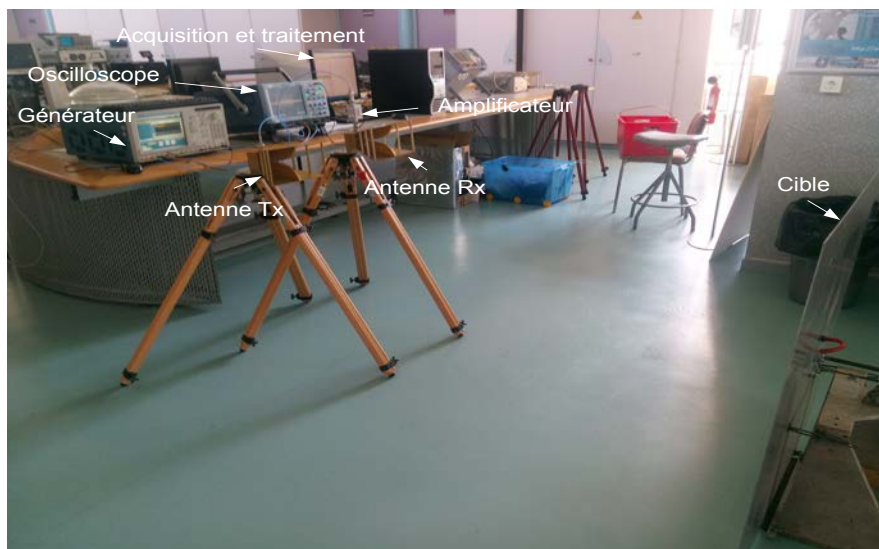
FIGURE 5.2 : Banc de test considéré, en environnement laboratoire.
