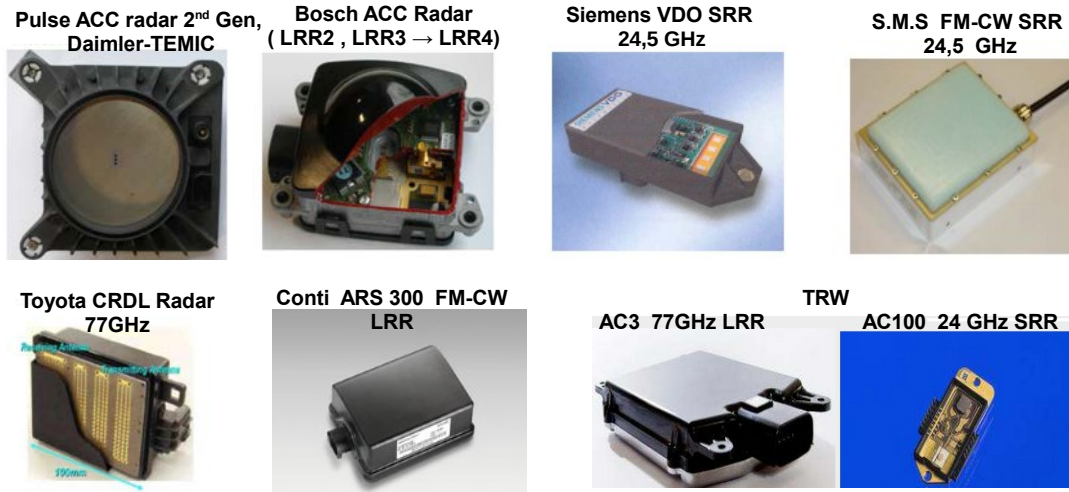
FIGURE 1.15 : Quelques radars LRR et SRR du commerce.
