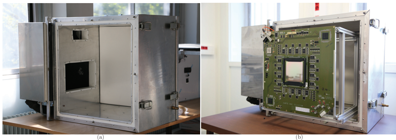
FIGURE 4.19 – Photo de l'enceinte thermique vide permettant de dissiper 400 W thermiques à -20^\circ\text{C} (a). La photo de droite (b) montre une carte DAQ fixée sur un support coulissant permettant de maintenir et de positionner les cartes DAQ dans l'enceinte thermique.
