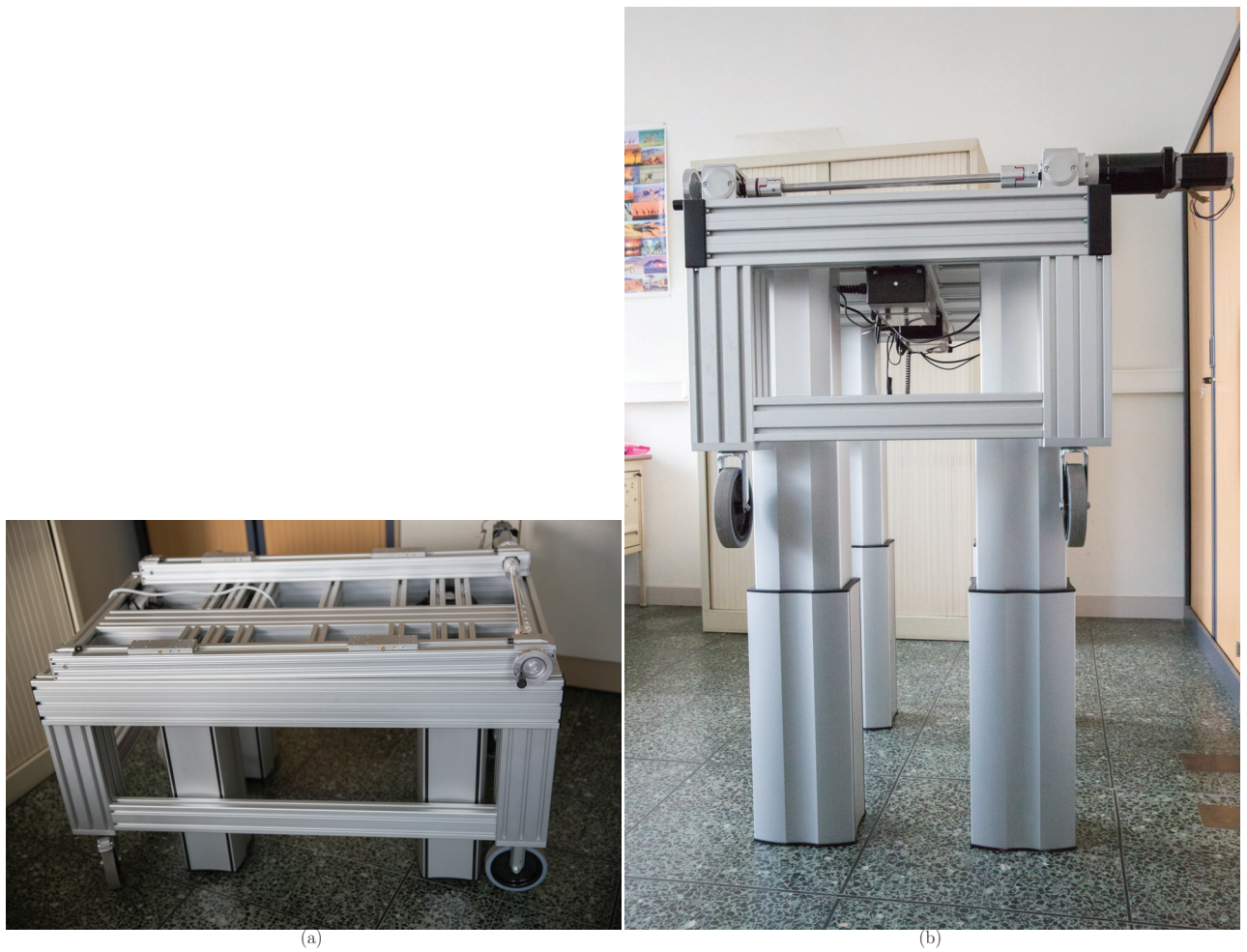
FIGURE 4.27 – (a) Table de positionnement abaissée au maximum. (b) Table en position haute maximale. Le premier des axes de translation est visible sur la table.
