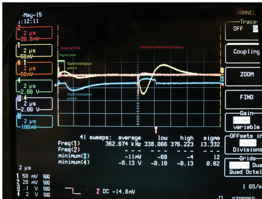
FIGURE 5.11 – Capture d'écran de l'oscilloscope montrant les signaux analogiques suite à un signal de reset de l'ASIC V2 et suite à la détection d'une particule dans le silicium. Pour la remise à zéro de l'ASIC V2, le signal reset engendre un signal analogique sur les voies énergie des pistes P et N. La détection d'une particule se manifeste par un signal rapide (signal rouge) sur une piste et la génération d'un signal analogique sur une piste N et sur une piste P. Signaux acquis avec une source radioactive de calibration.
