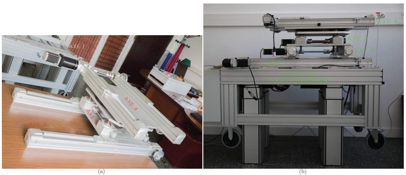
FIGURE 4.28 – (a) Axes de translation 2, 3 et 4 comme décrit précédemment. (b) Table de positionnement avec le système d'axes de translation installé.
