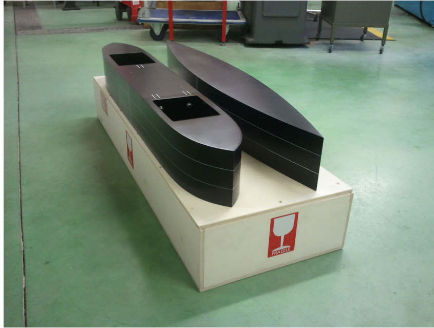
Figure 2.19 – Les modèles réduits de carènes CWn2 (droite) et CWn8 (gauche), de dimensions L \times B \times T = 1,20 \times 0,18 \times 0,15 \text{ m}^3 .
