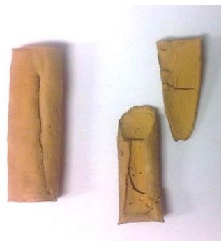
Figure 98: Photographie d'un polyEC fissuré
