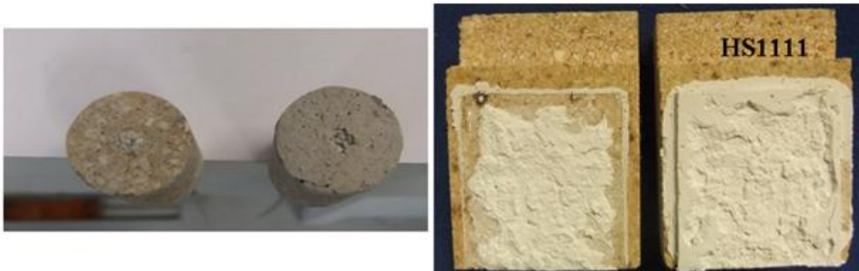
Figure 3.24. Faciès de rupture des essais de traction directe (face rectifiée) et de propagation de fissures (face non rectifiée)
