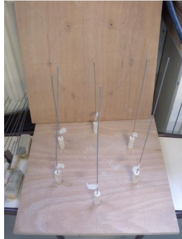
Figure 3.22. Dispositif de mise en compression
