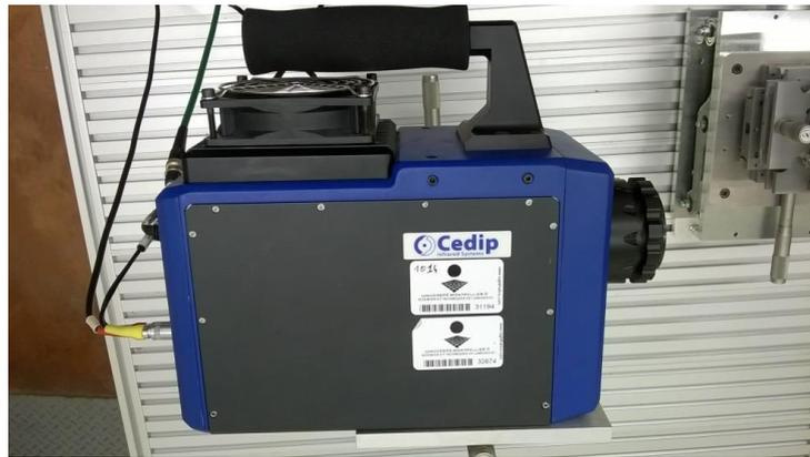
**FIGURE 3.9** - *Caméra InfraRouge Titanium SC7000.*
