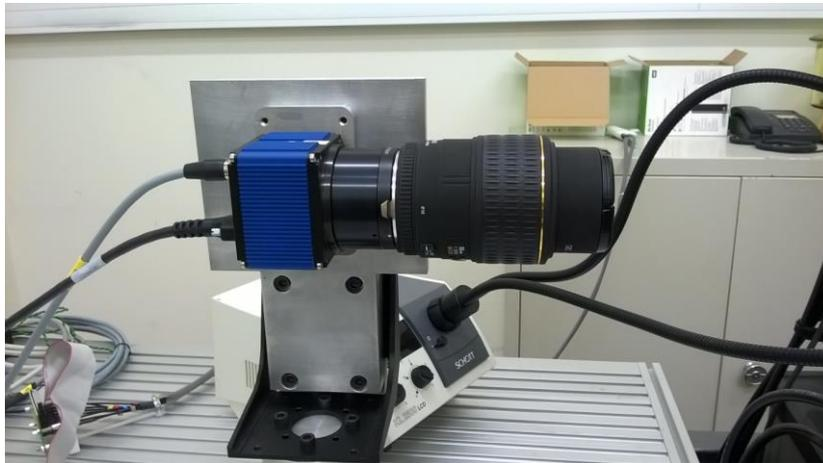
***FIGURE 3.2 - Caméra Haute Résolution 16 mégapixels.***
