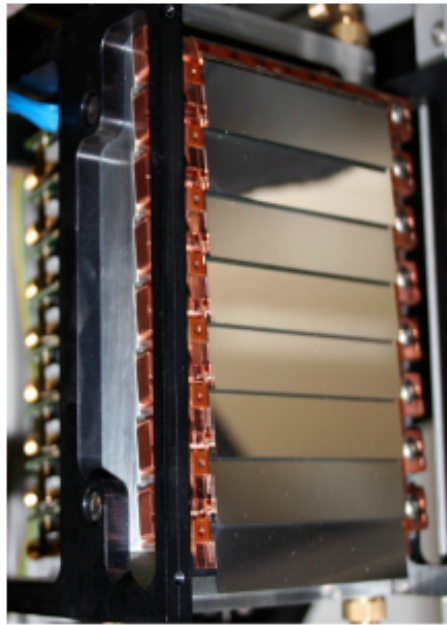
Figure 2.16 Photographie du détecteur complet XPAD3.2 : 8 barrettes.
