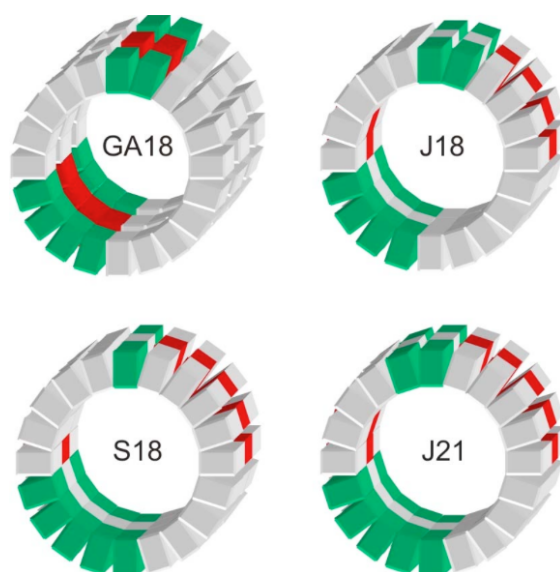
Figure 2.2 Différentes géométries de détection possibles. La position des modules du premier et du troisième anneau sont représentées en vert et celle de l'anneau central en rouge (Khodaverdi et al., 2007).
