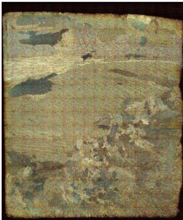
Figure E-38 : Macrostructure de la face extérieure de l'échantillon n°5.
