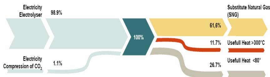
Figure 16 : Diagramme de Sankey du procédé EtoGas (Rieke, 2012)
