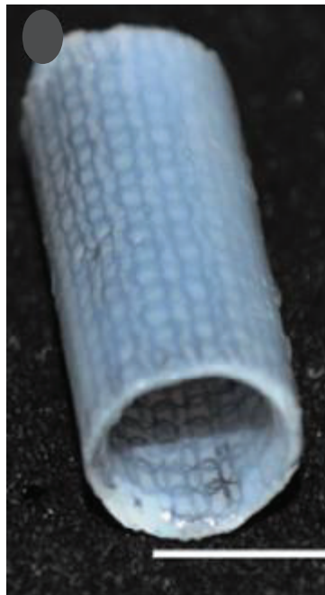
Figure 25: Stent recouvert d'un hydrogel ELR bioactif pour l'ingénierie vasculaire. Les ELR contenus dans l'hydrogel ont été fonctionnalisés avec les séquences bioactives RGD et REVD connues respectivement pour être des séquences de reconnaissance des intégrines \alpha_5\beta_1 , \alpha_v\beta_1/\beta_3/\beta_5/\beta_6/\beta_8 et \alpha_8\beta_1 et des cellules endothéliales (de Torre, Wolf et al. 2015).
