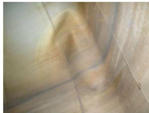
B. Cloque d'un liner PVDF
