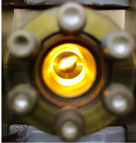
FIGURE 3.3 – Photographie d'un nuage contenant près de 10^9 atomes de sodium capturés dans un piège magnéto-optique. Le nuage est légèrement tourné car le champ magnétique résiduel dans l'enceinte n'est pas compensé.
