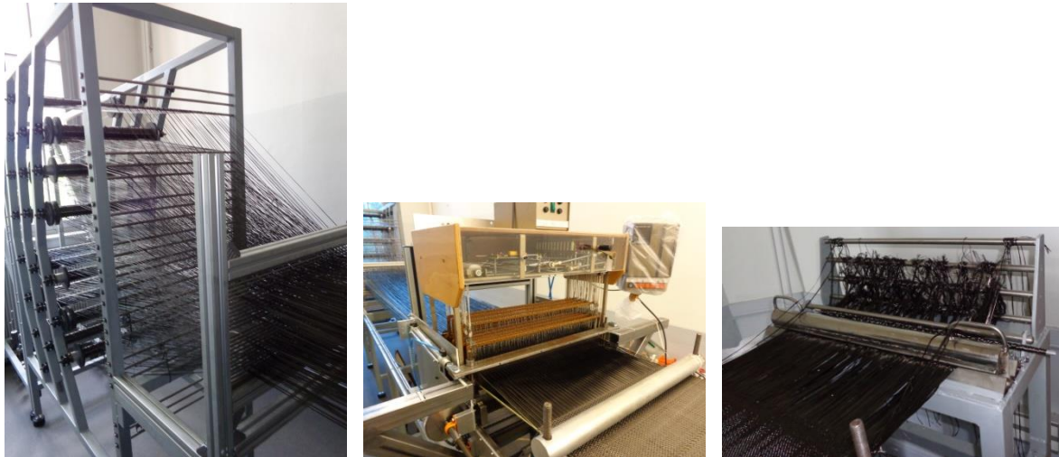
Figure 89. (gauche) Système de mise en tension individuelle des ensouples sur cantre - (milieu) système de sélection des cadres et d'insertion de fil de trame manuelle par navette - (droite) système de blocage des nappes de fils de chaîne.
