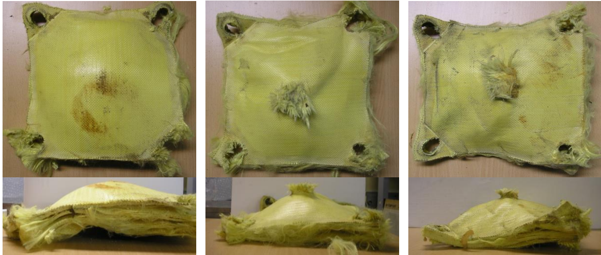
Figure 149. Représentations en vue de face arrière (haut) et en vue de côté (bas) du backing composite type Tissu 2D prepreg 10 mm après impact d'un FSP (diamètre 20 mm, masse 54 g) pour une vitesse d'impact de : (gauche) 1610 m/s - masse surfacique = 153 kg/m 2 - non perforation, (milieu) 1740 m/s - masse surfacique = 151,6 kg/m 2 - perforation, (droite) 1808 m/s - masse surfacique = 153,5 kg/m 2 - perforation.
