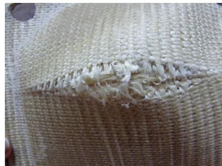
Figure 144. Représentation de la forme d'endommagement uni-directionnelle en face arrière du tissu (gauche) Interlock O - liage L 1-2-13 (fils para-aramide Kevlar 29 (3300 dTex)) avec fils de chaîne de surface à 20 fils de chaîne/cm et 130 fils de trame/cm impacté par un FSP (diamètre 20 mm, masse 54 g) à une vitesse initiale de 700 m/s - (droite) Interlock O - liage L 1-2-13 (fils polyester aromatique Vectran (2x1650 dTex)) avec fils de chaîne de surface à 20 fils de chaîne/cm et 130 fils de trame/cm.
