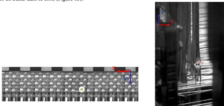
Figure 65. (gauche) Positionnement d'un point de repère sur le tissu - (droite) positionnement d'un point de repère sur une lisse.
