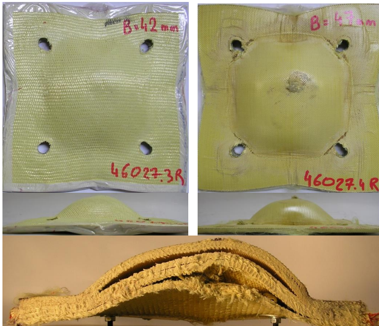
Figure 154. Représentations en vue de face arrière (haut) et en vue de côté (milieu) du backing composite type Tissu 3D ThPlastique 8 mm (gauche) et du backing composite de type Tissu 2D prepreg 5 mm (droite) après impact d'un FSP (diamètre 20 mm, masse 54 g) à une vitesse d'impact de 1666 m/s - masse surfacique = 155,2 kg/m 2 aboutissant à une non perforation - (bas) vue en coupe du backing composite de type Tissu 3D ThPlastique 8 mm + Tissu 2D prepreg 5 mm après impact.
