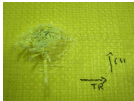
Figure 143. Représentation de la forme d'endommagement localisée en face arrière du tissu Interlock O - liage L 1-2-13 (fils para-aramide Kevlar 29 (3300 dTex)) avec fils de chaîne de surface à 40 fils de chaîne/cm et 52 fils de trame/cm impacté par un FSP (diamètre 20 mm, masse 54 g) à une vitesse initiale de 620 m/s.
