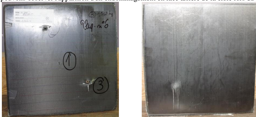
Figure 134. Observations de la cible à 300 plis d'UD (pré-imprégné T700/résine époxy M10R) après impact à 924 m/s de 3 tirs de munition de type 7,62 × 51 mm AP WC (type AP8) - (gauche) face avant - (droite) face arrière.
