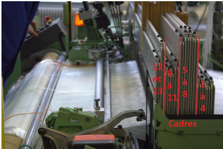
Figure 79. Positionnement des fils de chaîne sur les cadres de la machine à tisser industrielle pour le tissage de tissus 3D interlocks chaînes.
