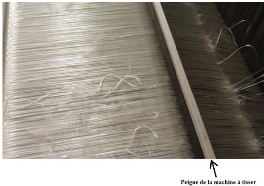
Figure 90. Observation des casses de fils de chaîne lors de la production des tissus interlocks en fils de verre E de titrage 300 Tex.
