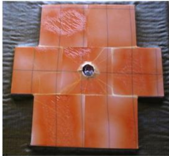
Figure 136. Cible céramique et composite à base de tissu 3D interlock chaîne (gauche) avant impact - (droite) après impact par une munition perforante de 12,7mm AP à 610 m/s selon la norme MIL-PRF-46103E type III [72].
