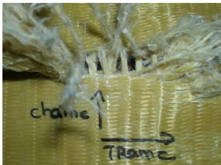
Figure 144. Représentation de la forme d'endommagement uni-directionnelle en face arrière du tissu (gauche) Interlock O - liage L 1-2-13 (fils para-aramide Kevlar 29 (3300 dTex)) avec fils de chaîne de surface à 20 fils de chaîne/cm et 130 fils de trame/cm impacté par un FSP (diamètre 20 mm, masse 54 g) à une vitesse initiale de 700 m/s - (droite) Interlock O - liage L 1-2-13 (fils polyester aromatique Vectran (2x1650 dTex)) avec fils de chaîne de surface à 20 fils de chaîne/cm et 130 fils de trame/cm.
