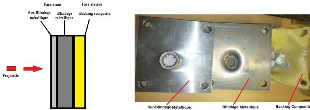
Figure 146. (gauche) Représentation schématique d'une cible composée en face avant d'un sur blindage et blindage métallique et en face arrière d'un backing composite soumis à l'impact d'un FSP (diamètre 20 mm, masse 54 g) à 1600 m/s selon la norme STANAG 4569 [76] - (droite) Observation des plaques de sur-blindage et blindage métallique perforées et du backing composite non perforé.
