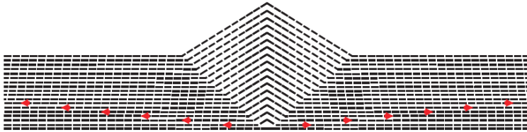
Figure 95. Configuration du fil chaque 40 \times 10^{-6} s du fil élastique après un impact transversal de 180 m/s avec la propagation de l'onde longitudinale (flèche) et le déplacement des points matériels (espaces entre les tirés) [14].
