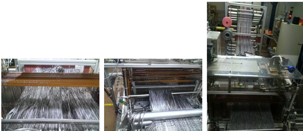
Figure 88. (gauche) passage des fils de chaîne dans les lisses des cadres - (milieu) insertion automatique du fil de trame par lance rigide unilatérale dans la foule formée par les fils de chaîne du tissu 3D interlock chaîne - (droite) vue complète du système de sélection automatique des cadres et mise en tension des fils de chaîne.
