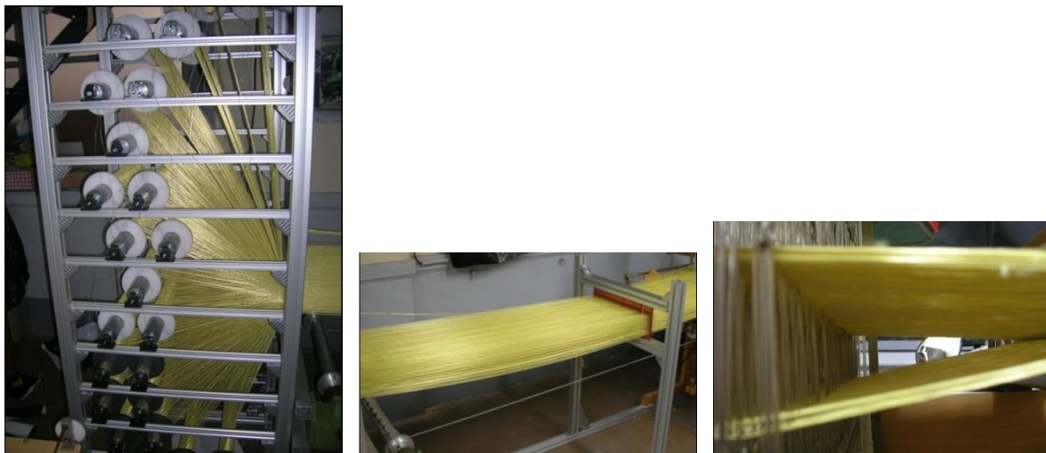
Figure 92. (gauche) Centre des ensouples de fils de chaîne - (milieu) positionnement des fils de chaîne dans les planches d'empoutage - (droite) Ouverture de la foule sans fibrilles.
