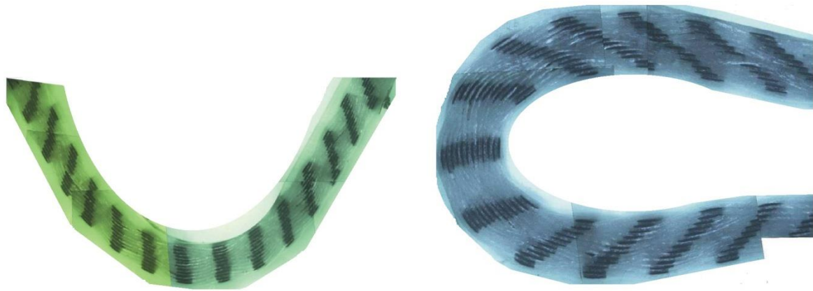
Figure 54. Vues en coupe des fils de chaîne des différentes étapes en pliage des tissus 3D interlocks chaînes (gauche) à 135° - (droite) à 180°.
