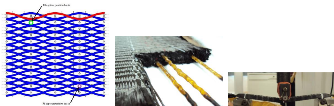
Figure 46. (gauche) position des fils capteurs au sein de la structure tissée 3D interlock chaîne - (milieu) fils de trame insérés dans le tissu 3D interlock chaîne (Interlock O - L 1-1-13) - (droite) échantillon résiné soumis à un test de flexion 3 points quasi-statique dans l'épaisseur.
