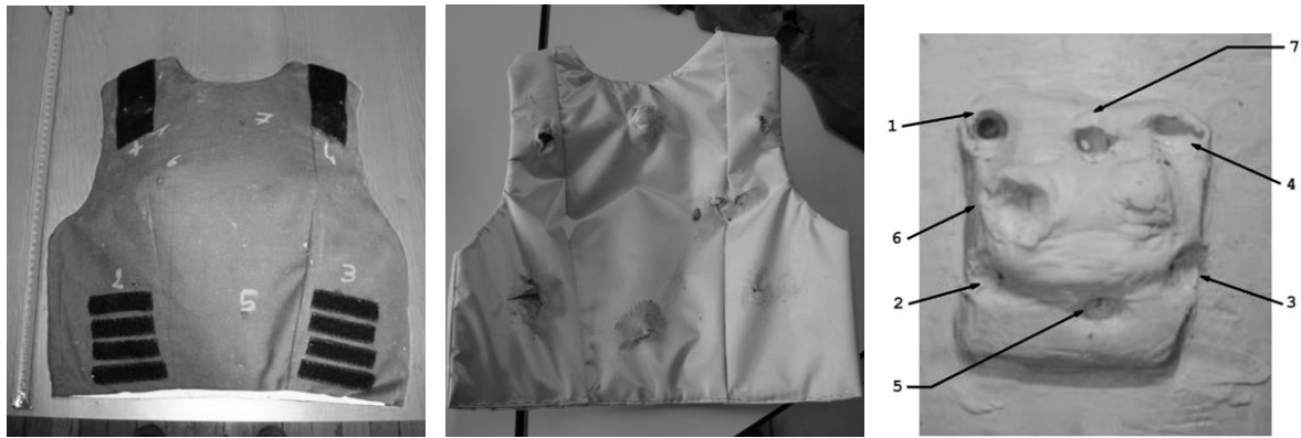
Figure 131. (gauche) face avant du gilet pare-balles avec la localisation des 6 points d'impact - (milieu) visualisation des zones déformées en face arrière du gilet - (droite) empreintes des déformées dynamiques aux 6 points d'impact dans la plastiline Roma n°1.
