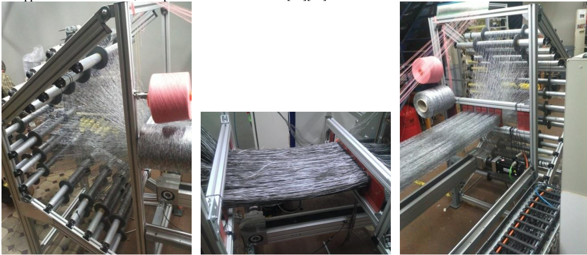
Figure 87. (gauche) Cantre des 24 ensouples de fils de chaîne - (milieu) Planche d'empoutage de positionnement dans l'épaisseur des fils de chaîne - (droite) Vue complète du cantre d'ensouples et planche d'empoutage et mise en tension des fils de chaîne.
