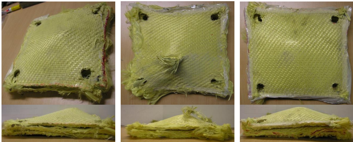
Figure 150. Représentations en vue de face arrière (haut) et en vue de côté (bas) du backing composite type Tissu 3D ThPlastique 13 mm après impact d'un FSP (diamètre 20 mm, masse 54 g) pour une vitesse d'impact de : (gauche) 1621 m/s - masse surfacique = 155,8 kg/m 2 - non perforation, (milieu) 1661 m/s - masse surfacique = 154,1 kg/m 2 - perforation, (droite) 1607 m/s - masse surfacique = 156,7 kg/m 2 - non perforation.
