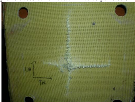
Figure 142. Représentation de la forme d'endommagement bi-directionnelle en face arrière du tissu Interlock A - Liage T 11-6-6 base sergé imbriqué de 6 effet trame cordon à droite (fils para-aramide Kevlar 29 (3300 dTex)) avec 40 fils de chaîne/cm et 40 fils de trame/cm impacté par un FSP (diamètre 20 mm, masse 54 g) à une vitesse initiale de 640 m/s.
