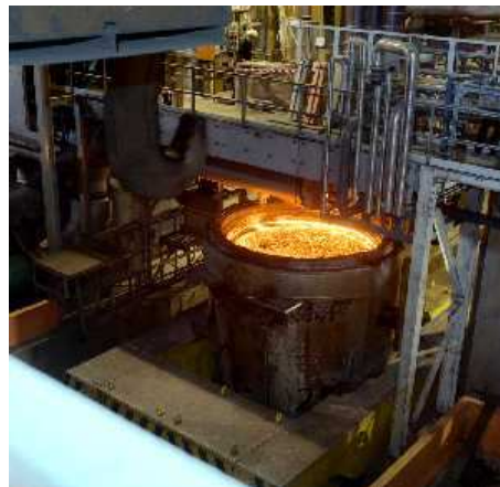
Figure 1.1 : Poche de traitement d'acier
