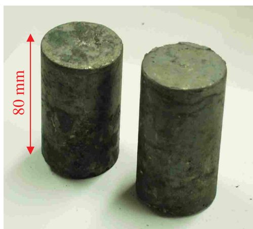
Figure 4.15 : Photo de deux lingots de l'alliage métallique final Sb-Li
